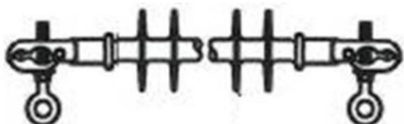
**Figura 1.** Forma del separador de fases.
