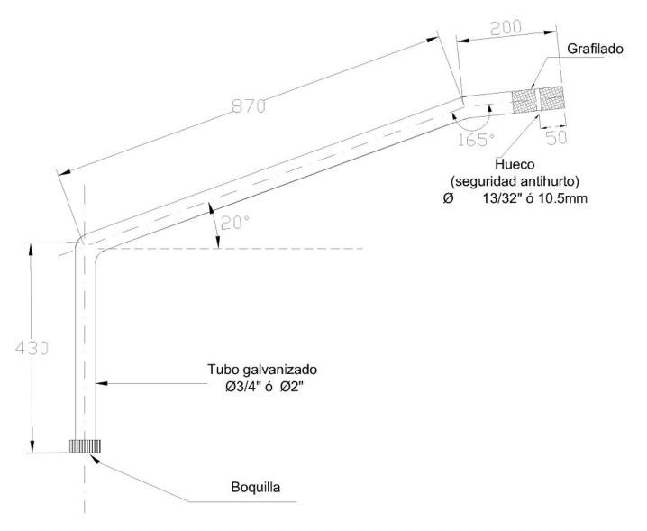
Longitud total del tubo 1500 mm Espesor del soporte 2 mm Dimensiones en mm y pulgadas
