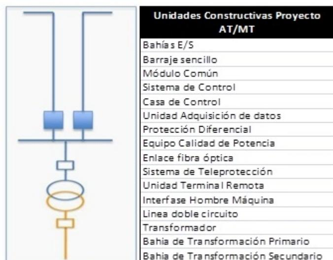
Figura 3. Unidades Constructivas Típicas Proyecto AT/MT 115 kV
