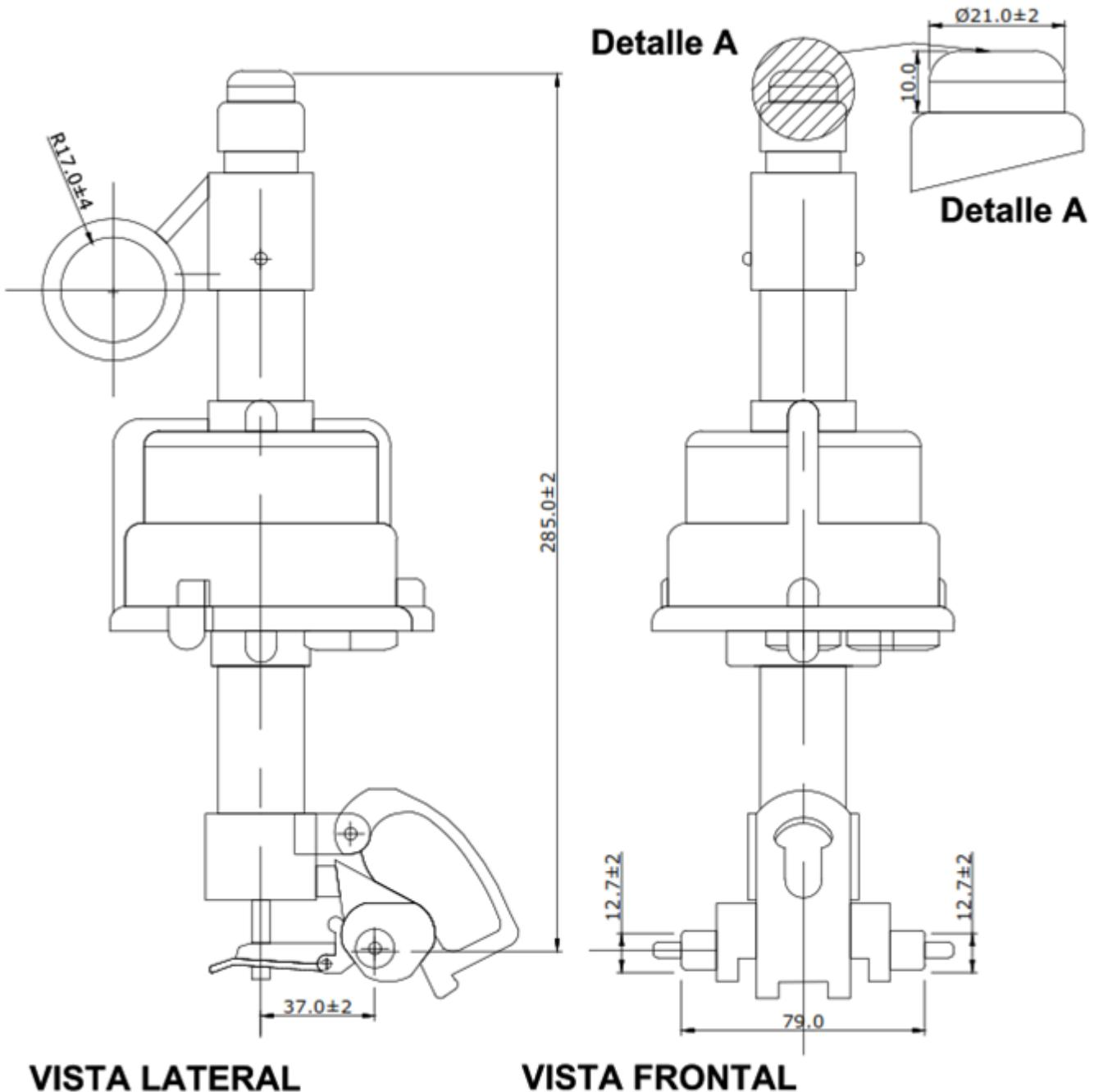
Figura 2. Dimensiones referenciales equipo 15 kV, en mm.
