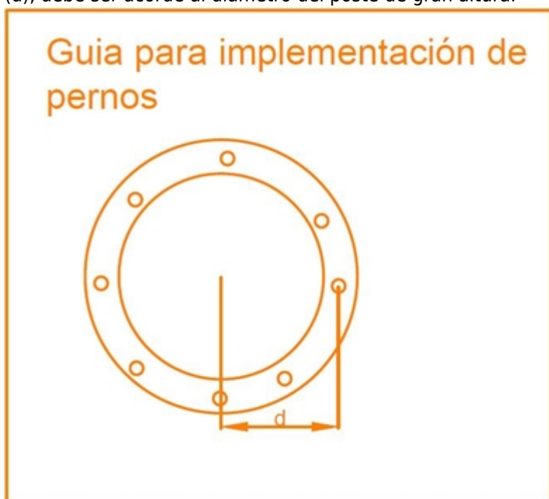
Figura 2. Guía para la implementación de pernos
