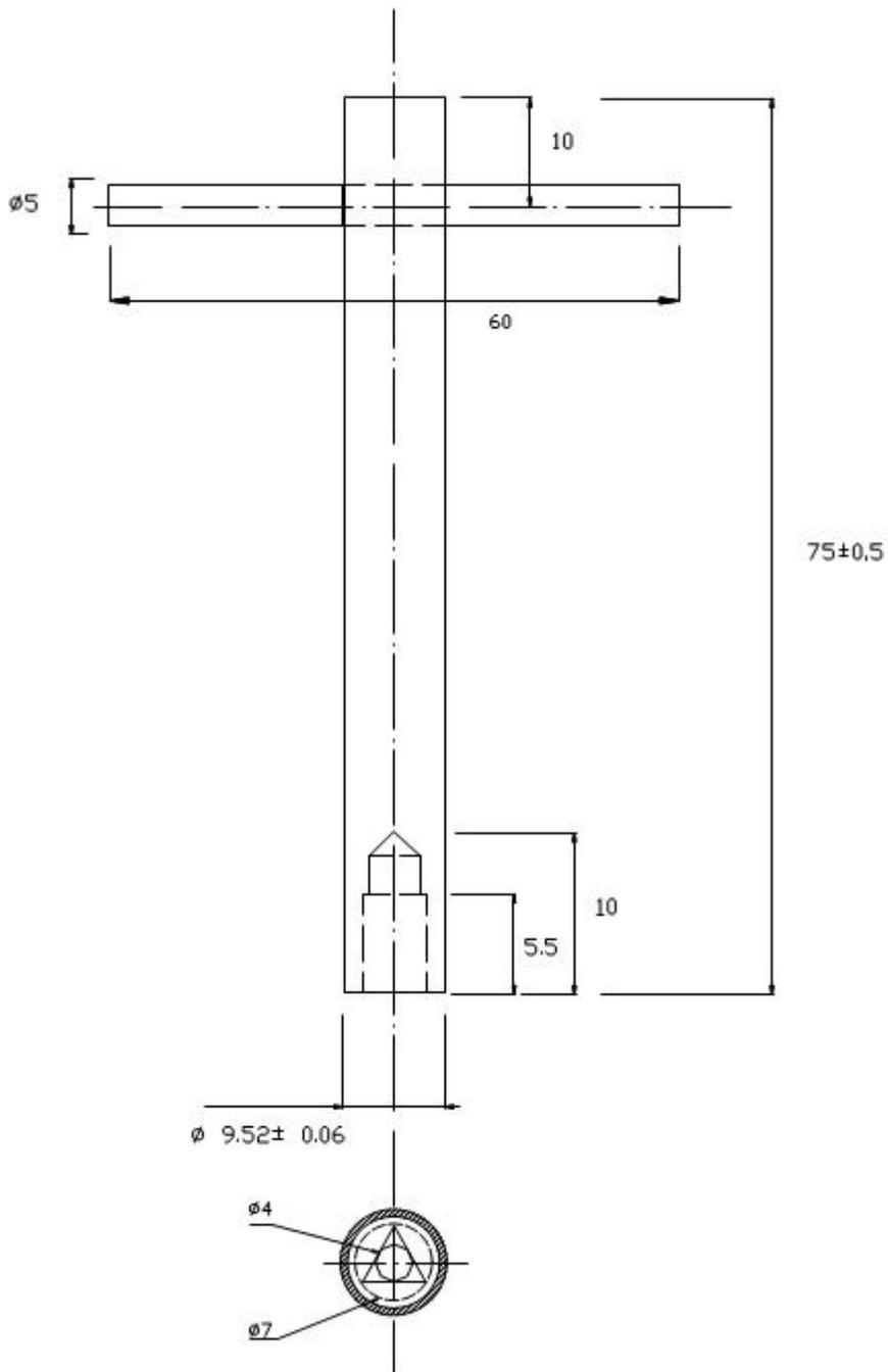
FIGURA 13. LLAVE PARA PERNO DE CABEZA TRIANGULAR
