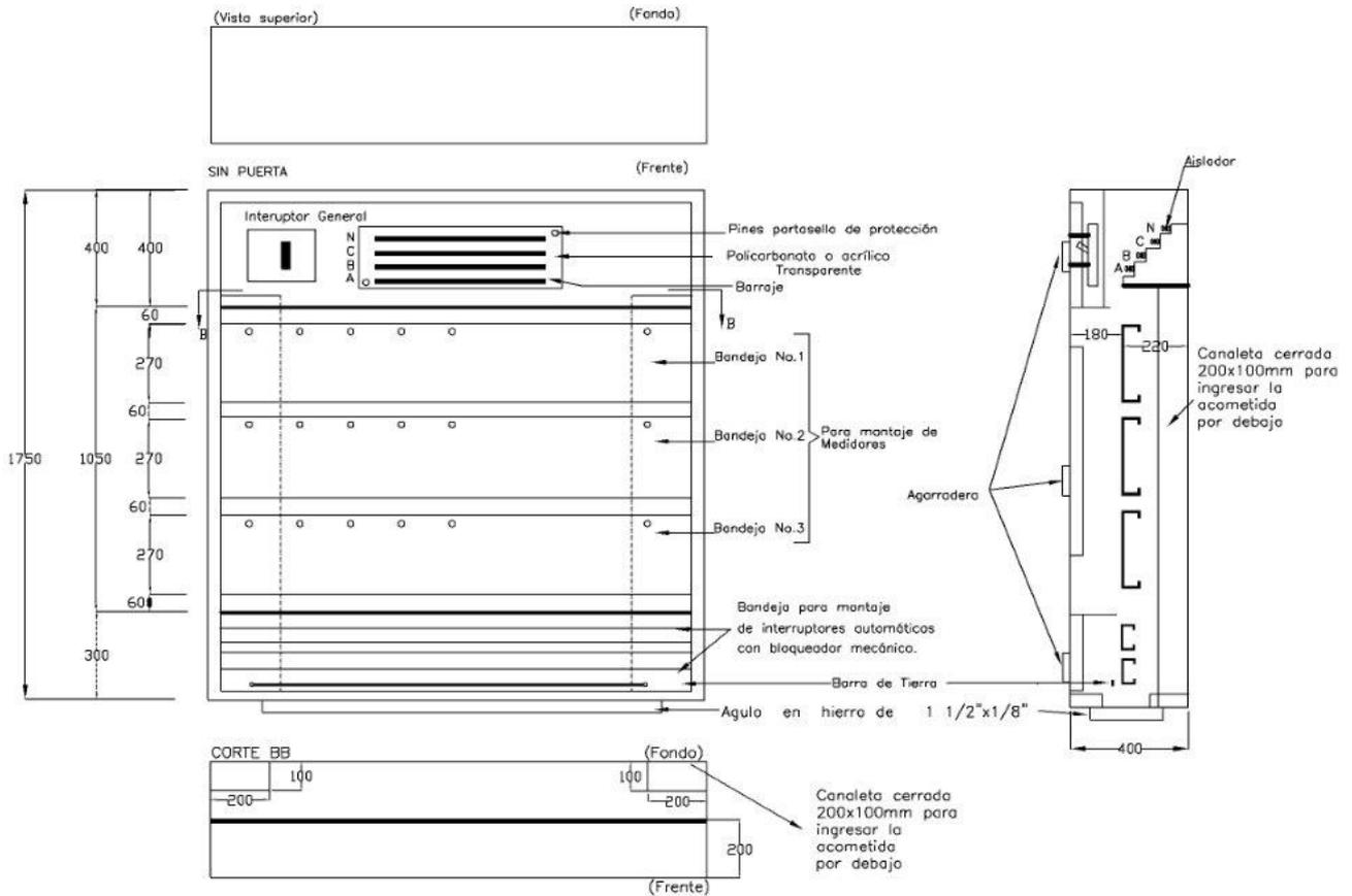
**FIGURA 3: ARMARIO DE MEDIDORES ACOMETIDA POR DEBAJO PARCIALES POR ENCIMA**
