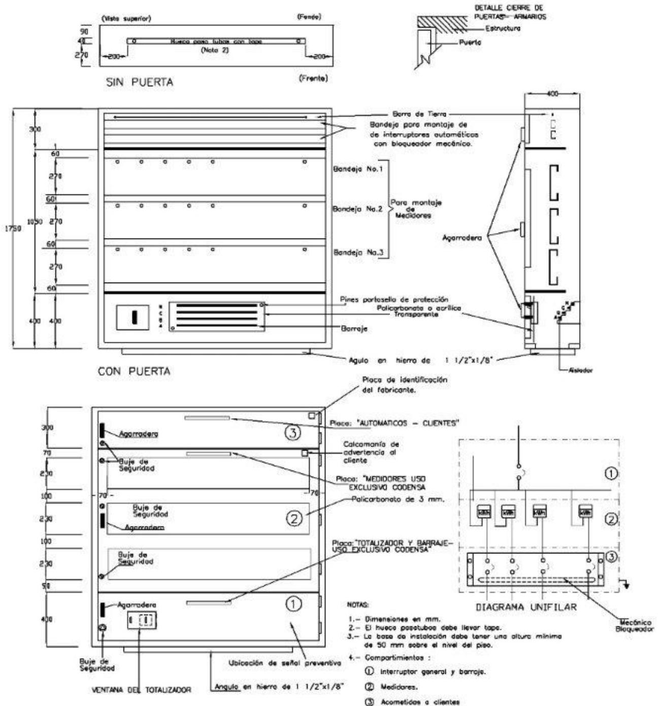
**FIGURA 3A: ARMARIO DE MEDIDORES ACOMETIDA Y PARCIALES POR ENCIMA**
