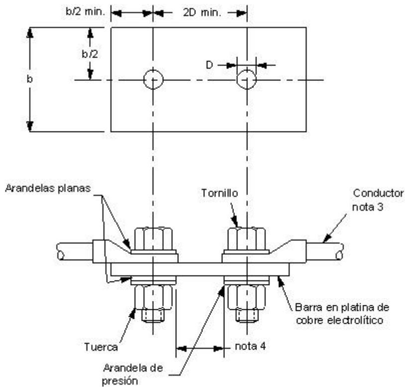
FIGURA 14. FIJACIÓN DE LAS DERIVACIONES DEL BARRAJE
