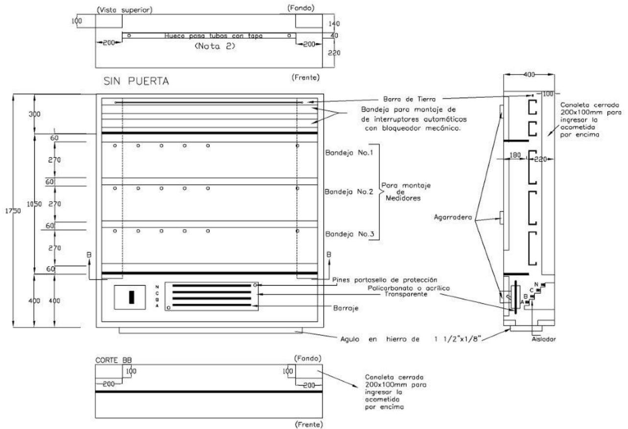
**FIGURA 4. ARMARIO DE MEDIDORES DE 18 A 24 CUENTAS TRIFÁSICAS ACOMETIDA POR DEBAJO PARCIALES POR ENCIMA**
