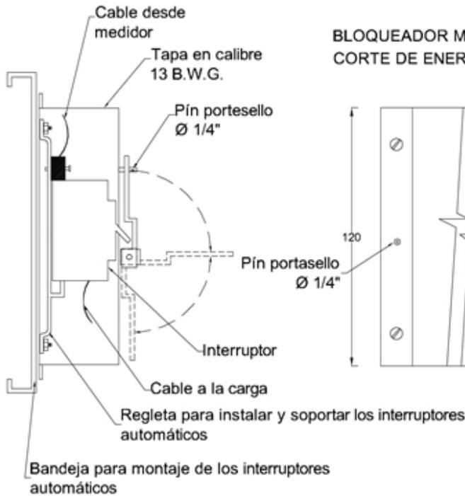
**BLOQUEADOR MECÁNICO PARA CORTE DE ENERGÍA**
