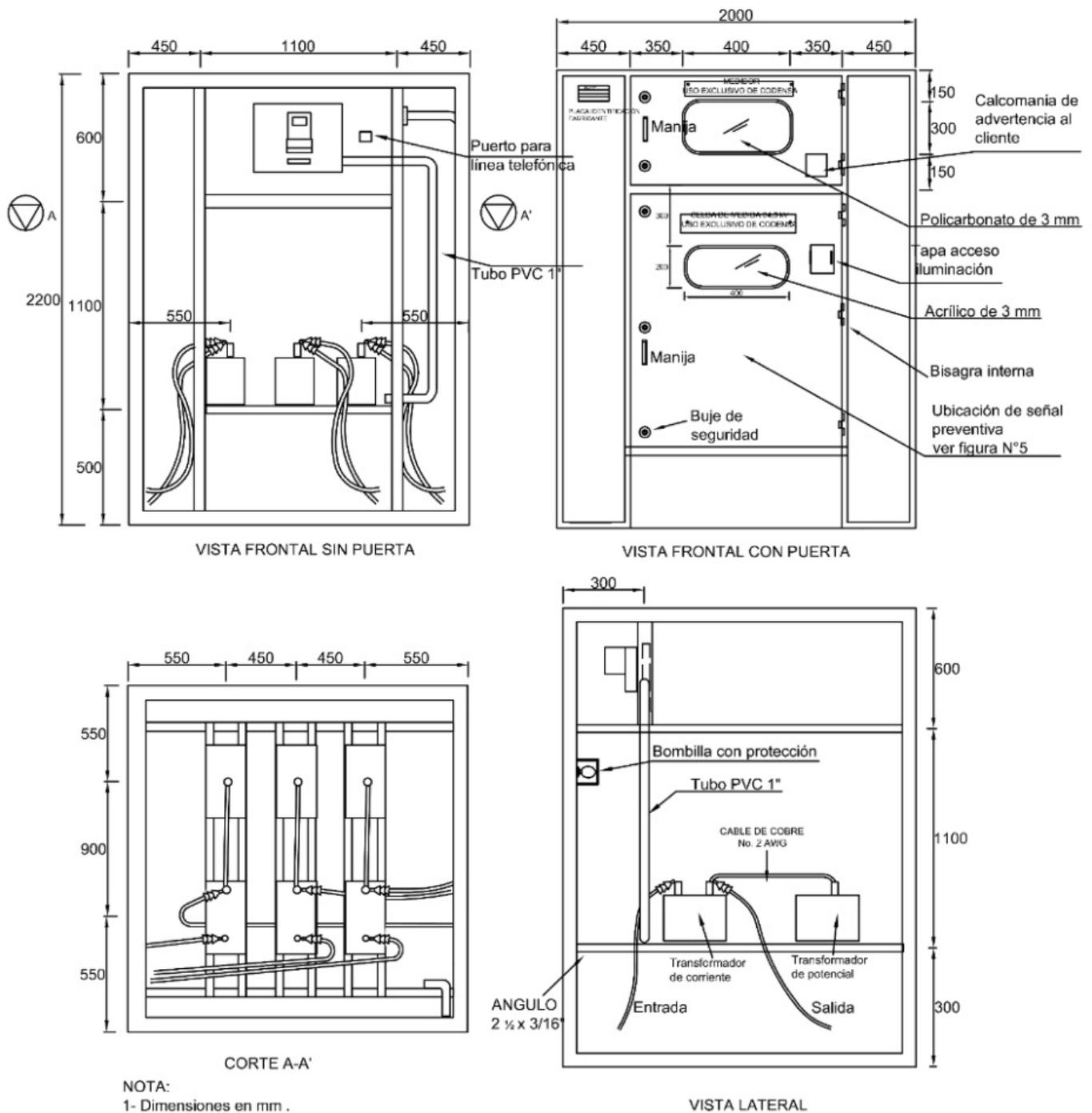
**FIGURA 7. CELDA DE MEDIDA EN 11,4kV y 13,2kV TIPO INTEMPERIE**
