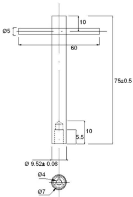
FIGURA 11. LLAVE PARA PERNO DE CABEZA TRIANGULAR
