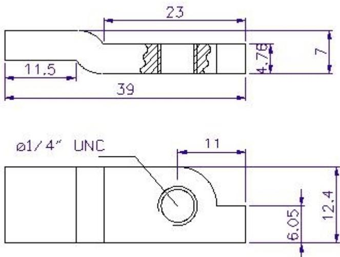
**FIGURA 16. LLAVE PARA PERNO DEL SISTEMA DE SEGURIDAD**
