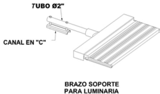
**Figura No. 3 Detalle soporte de corona móvil (Extracto de figura 6. Detalle soporte de corona móvil ET222)**
