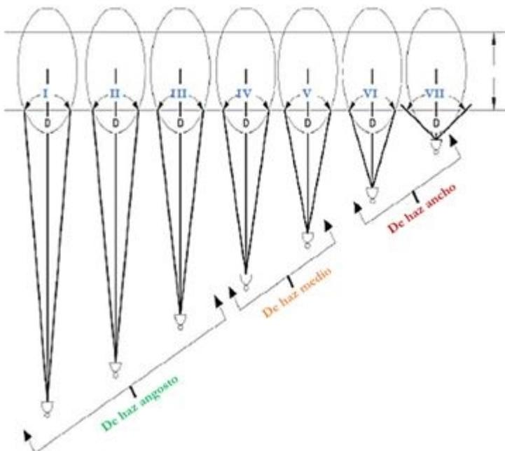
Clasificación del proyector teniendo en cuenta el ángulo de apertura del haz y la clasificación NEMA en Horizontal (H) y Vertical (V)
