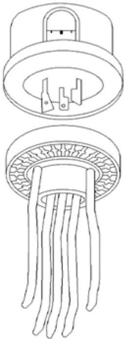
Figura 1 Base ANSI C136.41-2013 y fotocontrol
