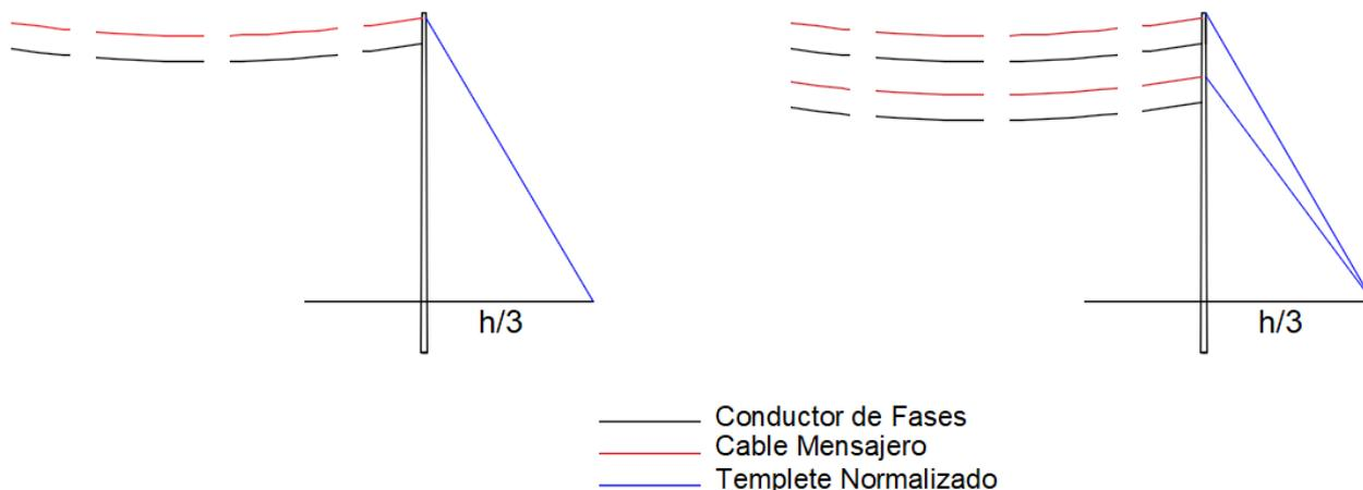
**Figura 3. Disposición para la instalación de templetos**
