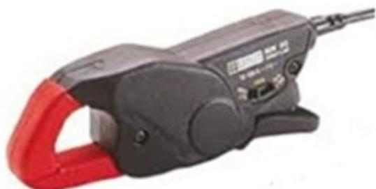
Pinzas AC con error compensado para medir hasta 120 A, de tamaño pequeño que permitan la medición del error de medidores de energía eléctrica en sitio, diámetro de la mordaza entre 10 mm y 30 mm. Los datos de corrección para la compensación del error de la pinza deben ser almacenados en una memoria EPROM localizada en el conector de la pinza, permitiendo su calibración independientemente de la unidad básica. El certificado de calibración debe ser trazable a estándares internacionales.
