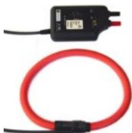
Este sensor flexible de corriente debe permitir la medición de corrientes de cualquier tipo de conductor con diámetros superiores a 50mm, y para magnitudes de corrientes de hasta 2.000 A.
