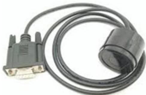
Sonda para la comunicación entre el Equipo Patrón y el medidor de energía bajo ensayo.
