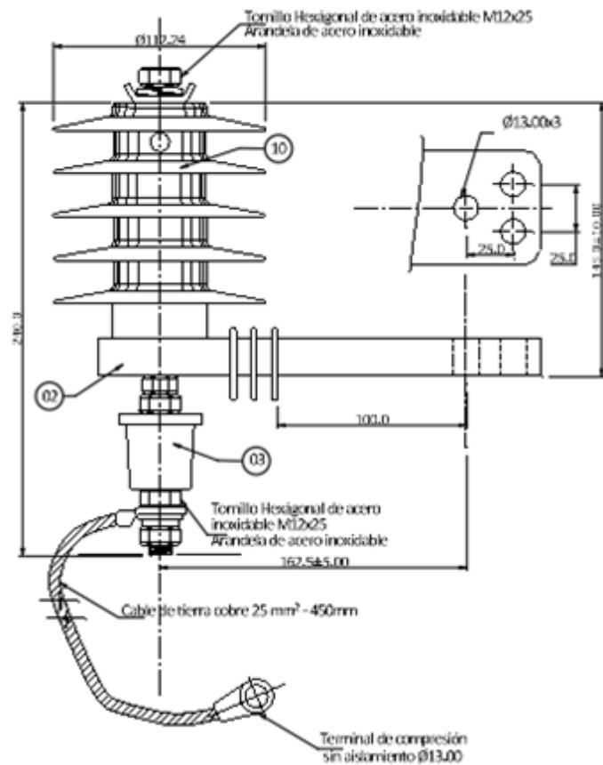
La [instalación](#) será sobre cruceta metálica (ET419).
