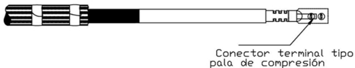
Figura 3. Instalación de la borna terminal
