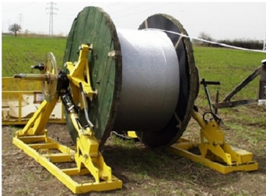
Figura 1. Bobina conductor con sistema de frenado
