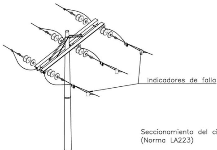
Seccionamiento del circuito principal
