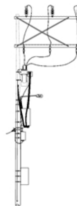
TRAFO EN POSTE CIRCUITO PRIMARIO CONSTRUCCIÓN EN BANDERA CTU 502
