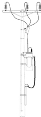
TRAFO EN POSTE USO DEDICADO CTU 520
