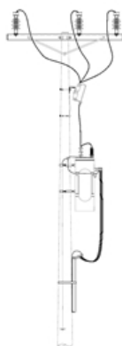
TRAFO EN POSTE USO DEDICADO CTU 520
