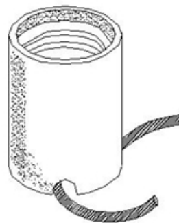
Cable aislado en silicona 200°C
