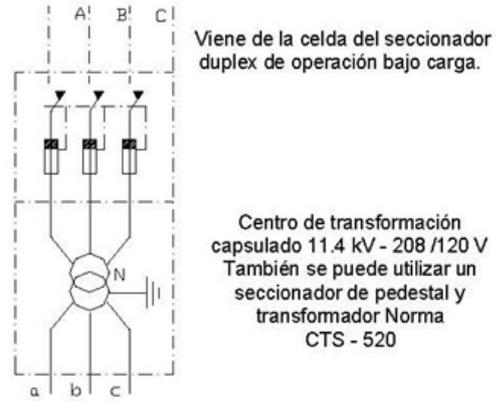
Seccionador portafusible fusibles NH.
