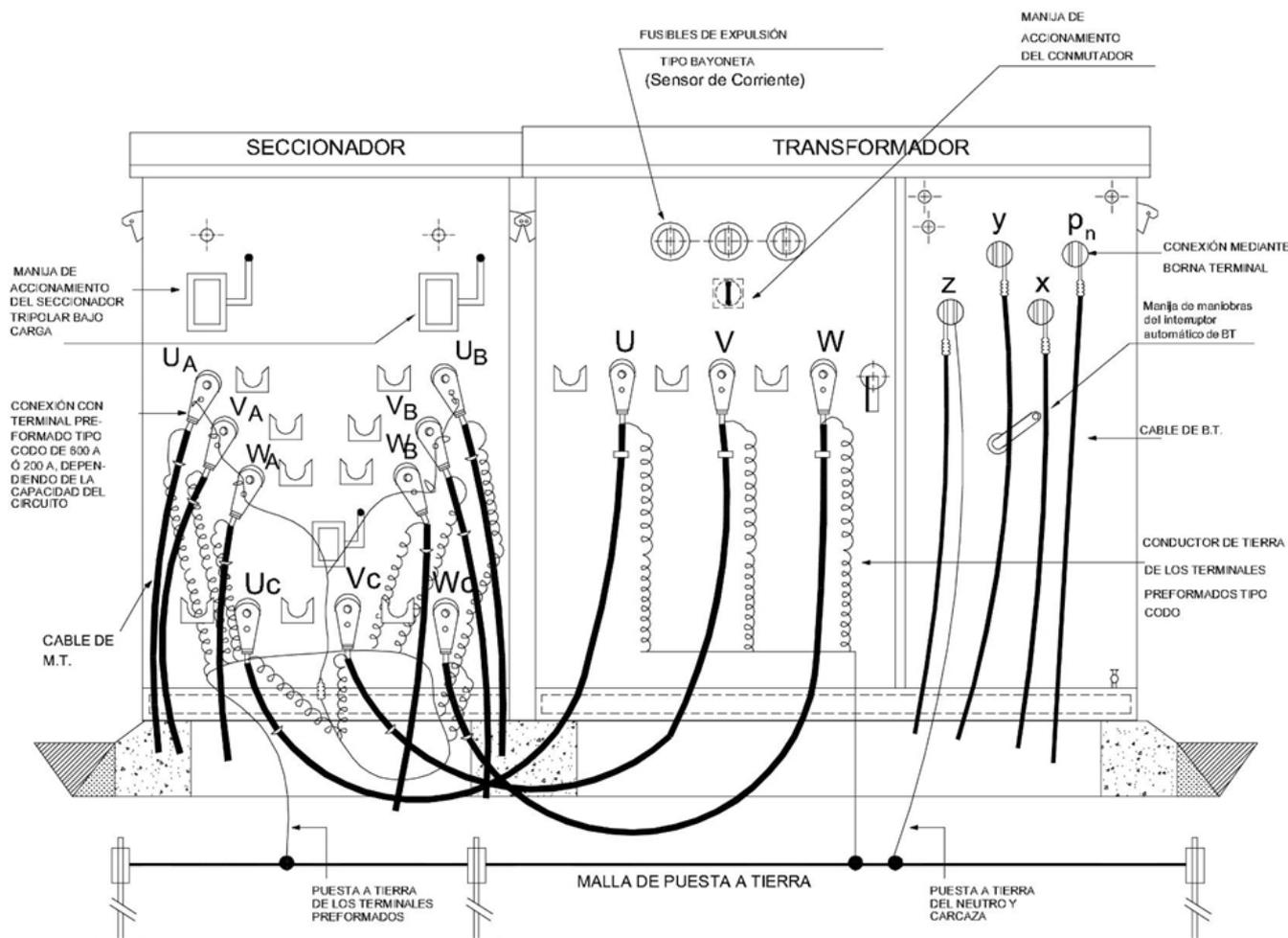
Para la conexión entre el seccionador y el transformador de pedestal se utilizarán ductos o el cárcamo
