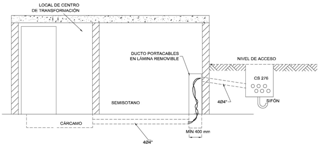
(1) POR UN DUCTO DEBE IR EL CABLE DE CONTINUIDAD DE TIERRA DE LAS CAJAS METÁLICAS
