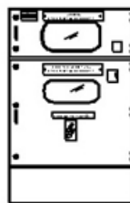
Celda de medida en 34,5 kV AE 326 AE 327
