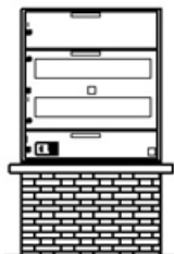
De 5 a 10 cuentas Dos filas de medidores AE 308
