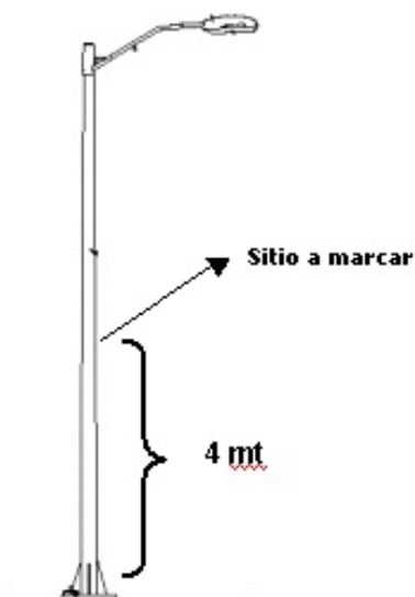
Figura 4 Altura Marcación postes metálicos
