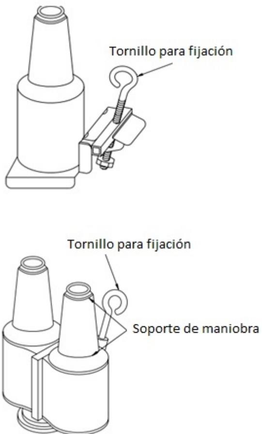
**FIGURA No 6. Descargador de sobretensiones tipo Codo**
